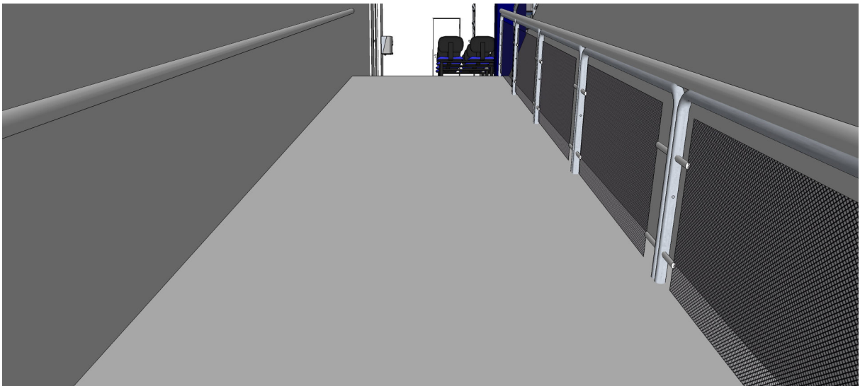
Figura 4.54 – Proposta de corrimão da rampa de acesso ao Ambulatório. Fonte: Autor (2013).
