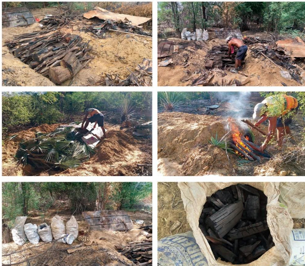
Figura 80 – Processo para fabricação do carvão, a partir da madeira da algaroba, (2019).
