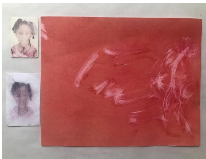
Figura 62 — Apagamento do toner e a transferência de uma imagem do couchê para o ofício a partir de uma a fricção
