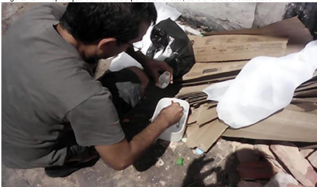
Figura 48 - Preparação da resina de poliéster cristal, adicionando o catalisador
